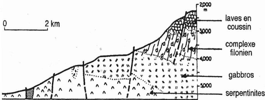
Coupe géologique synthétique du mur Sud de la zone de fracture Vema (Atlantique équatorial) d'après les observations effectuées par le submersible Nautille en 1988. D'après Auzende et al. (1988)
